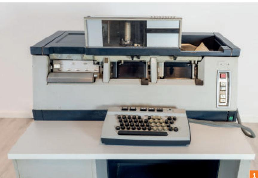
Lochkartenstanzer: Befehle werden in die Tastatur eingegeben und das Gerät stanzt diese als Löcher in die Karten
